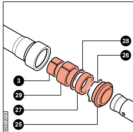
(30); pour séparer les deux éléments il est nécessaire de les tirer énergiquement. Cette opération permet de démonter du porte-fourreau le joint d'étanchéité (27), la cuvette (28) et la bague de glissement inférieure (29).
